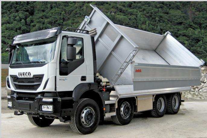
Sponda sinistra divisa longitudinalmente in due parti, apertura idraulica della sponda inferiore in alluminio tipo "BELMATIC II", incernierata su tutta la lunghezza. Sponda destra integrale con molle di richiamo, apribile sopra e sotto. Spondina posteriore superiore in alluminio con apertura a pendolo. Spondina inferiore pneumatica in Hardox con comando elettropneumatico.
