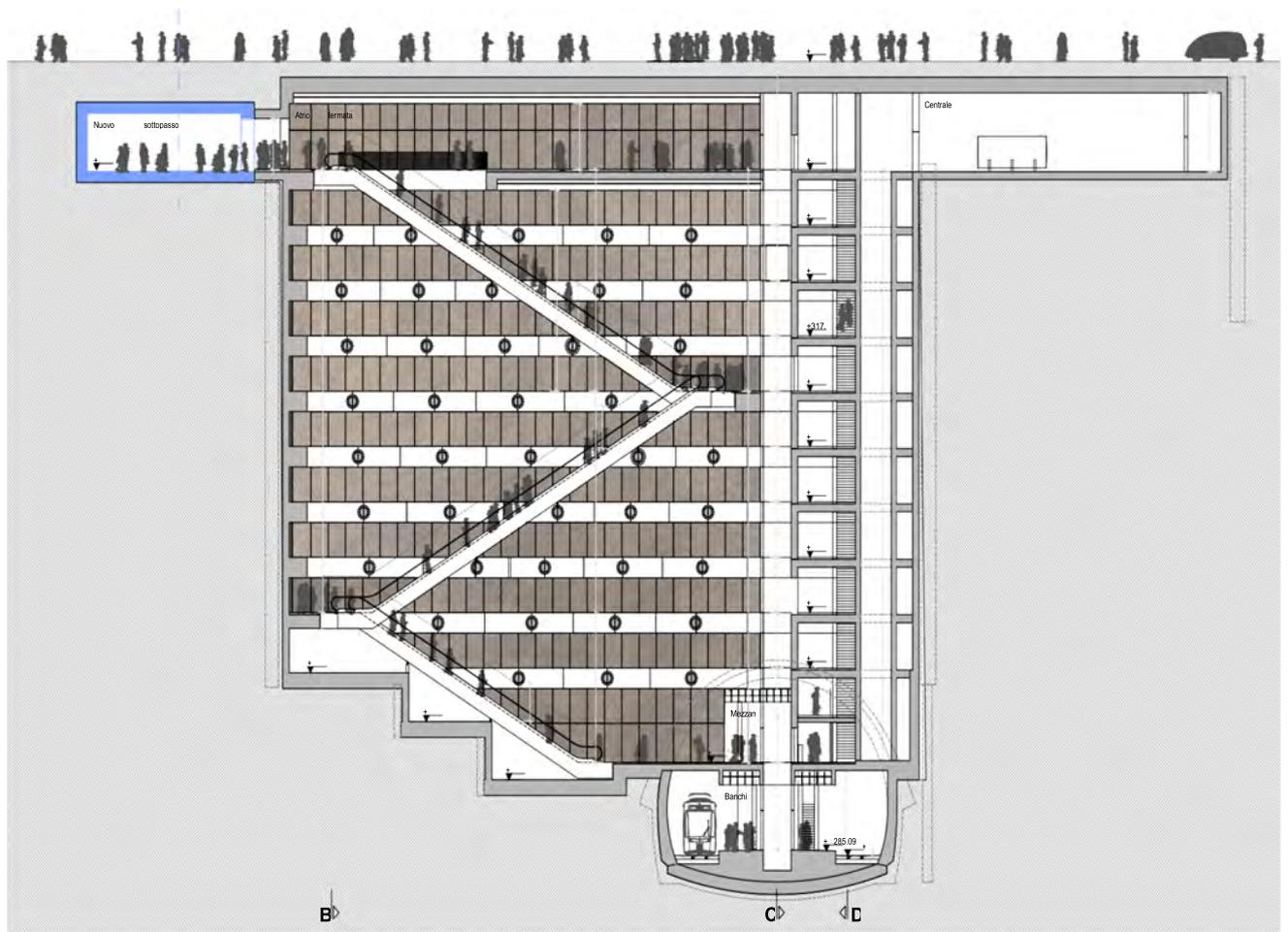
Figura 21.: Sezione del pozzo verticale di collegamento. In basso la stazione sotterranea, in alto a sinistra, colorato di blu, il nuovo sottopasso di Besso.
