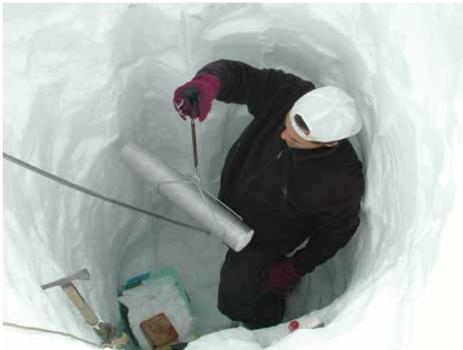
Misura della densità della neve per ricavare l'equivalente in acqua. Il volume è definito dal contenuto di un cilindro conficcato nei diversi strati della trincea e pesato.
