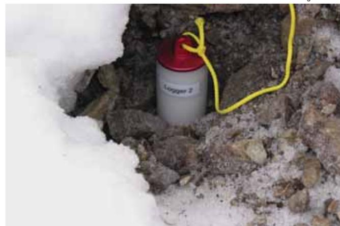
Datalogger UTL posato sul terreno per tutta la durata dell'inverno. Misura la temperatura del suolo ogni 6 ore. Misure BOT (*BodenOberflächenTemperatur*).
