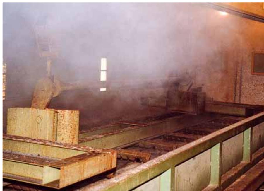
La captazione insufficiente dei vapori produce emissioni diffuse di inquinanti, molto difficili da abbattere.
