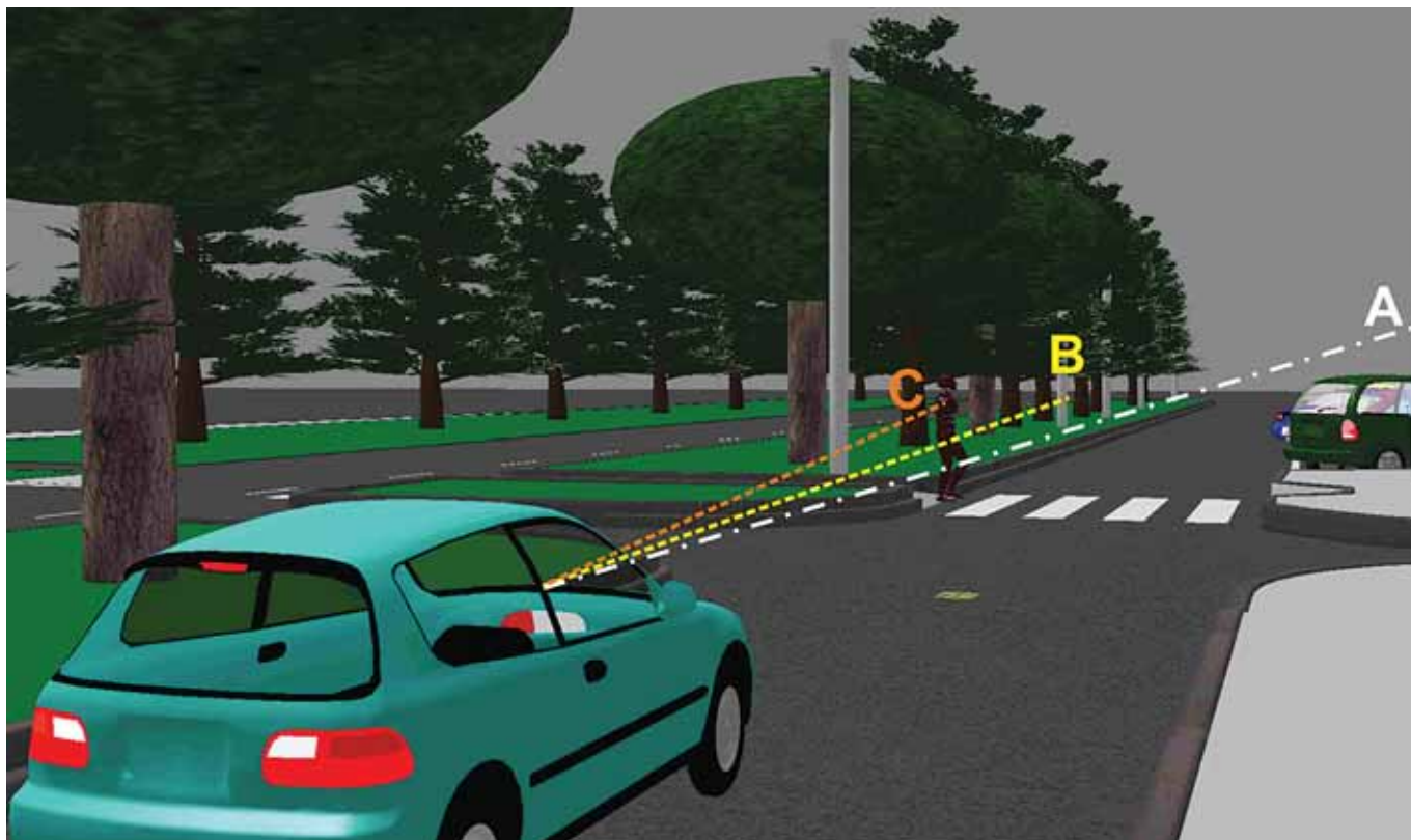
Angoli di visuale (A) riferiti al pedone (C) e ad un punto fisso di riferimento (B) o a punti congiunti (B-C).
