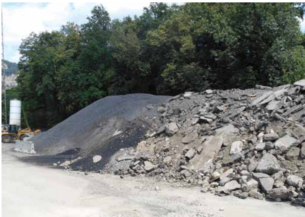
Foto: deposito di fessato e croste di asfalto
