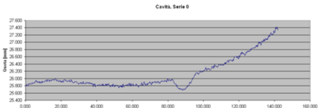
Figura 48: Profondità del difetto (cavità): 0.272mm
